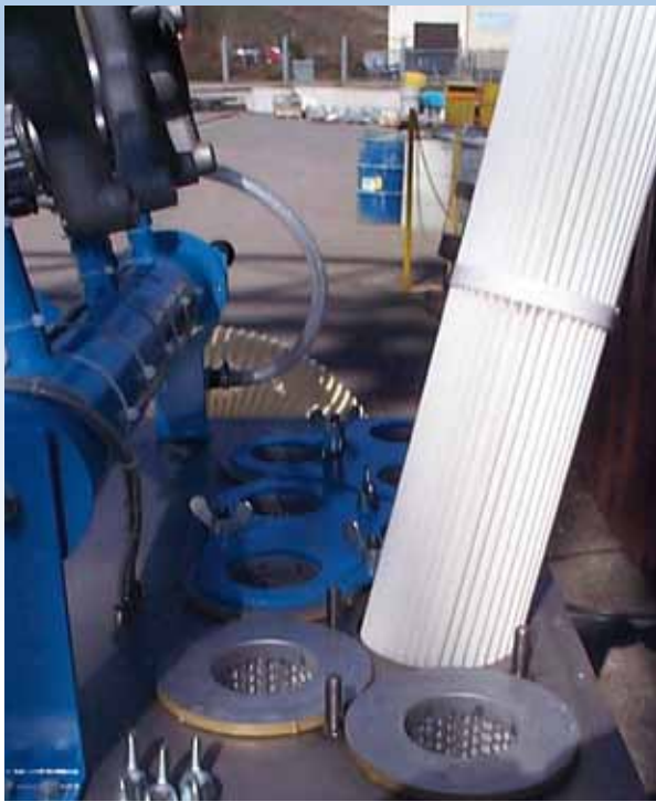
Montage d'une cartouche filtrante.
