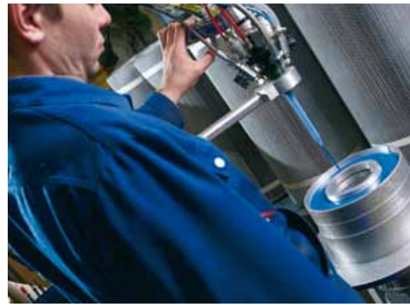
Moulage précis d'un disque.
