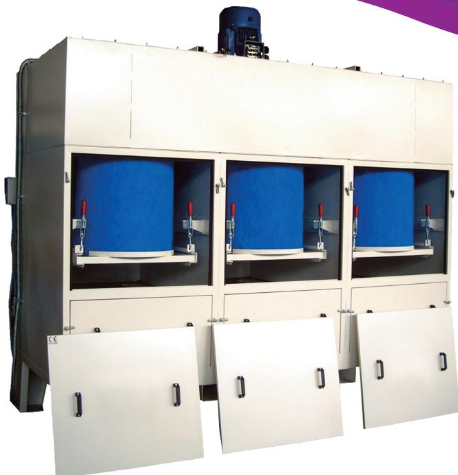
La gamme de filtres Aermist est conçue pour la filtration des émulsions et des brouillards d'huile.
