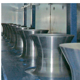
► Venturi de décolmatage
