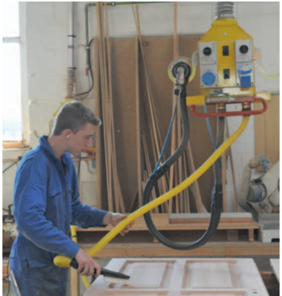
Figure 4. Exemple d'outil de nettoyage raccordé à un boîtier multi-énergies
