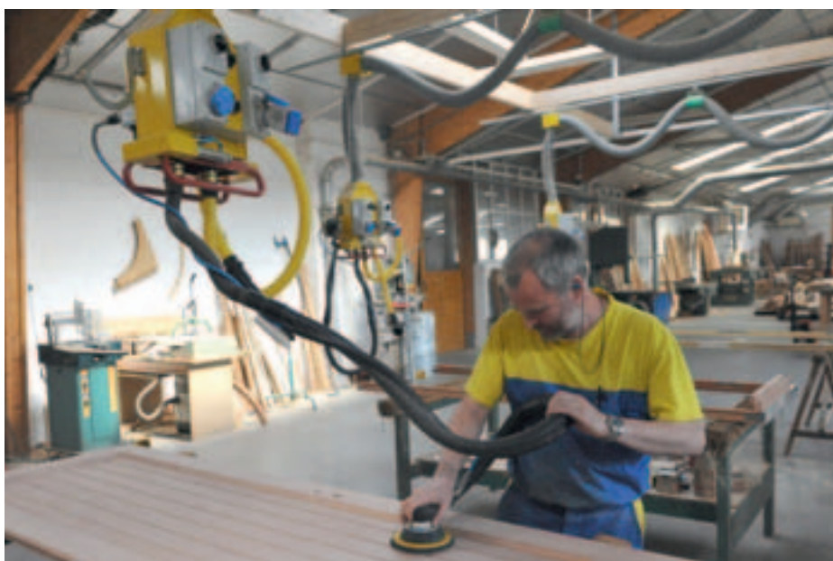
Figure 3. Exemple de ponçage avec aspiration intégrée
