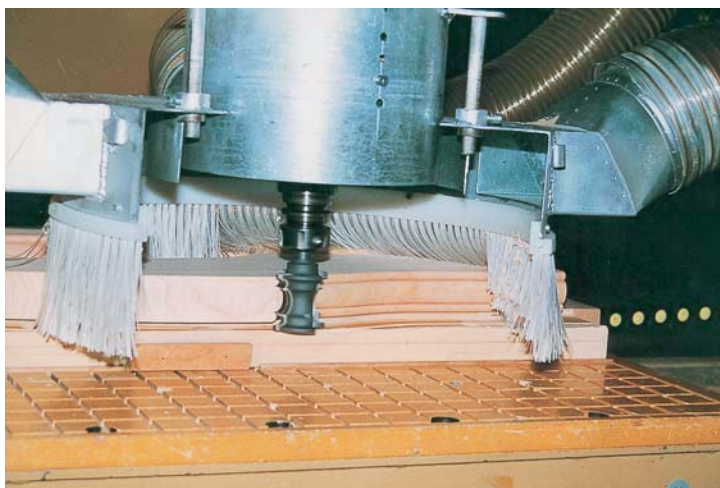
Exemple de dispositif de captage en position de travail (vu en écorché).
