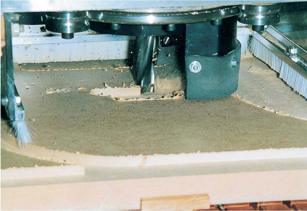
Exemple de dispositif de captage tournant en position de travail.
