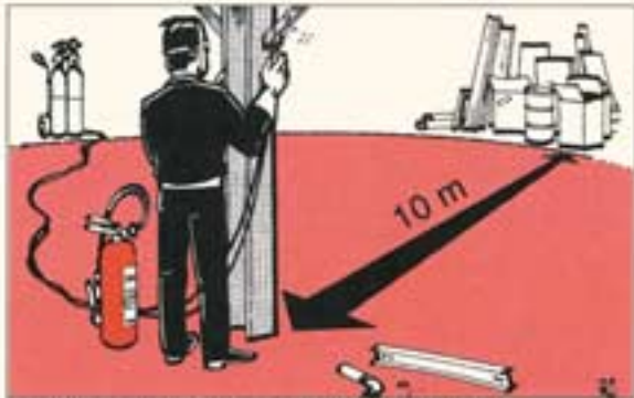
Figure 3 : les projections de particules incandescentes sont dangereuses jusqu'à plus de dix mètres
