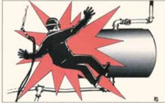
Figure 1 : explosion due à un dégazage incomplet
