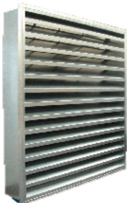
La grille acoustique GNB est utilisée pour l'atténuation des bruits de ventilation statique ou dynamique en façade de bâtiment. Sa conception vous apporte une double protection : pare pluie grâce au profil de lame spécialement étudié contre le bruit grâce au matériau isolant placé à l'intérieur des lames.
