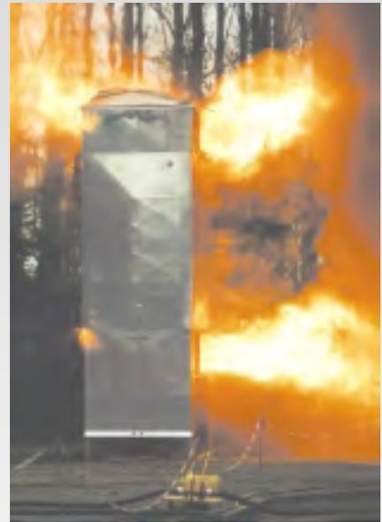
Schuko attache une grande importance au thème de la sécurité : toutes les installations de filtration sont fabriquées ou équipées de manière à répondre aux exigences des directives VDI, en particulier de la directive VDI 3673 Feuille 1, décharge de la pression d'explosion des poussières.
