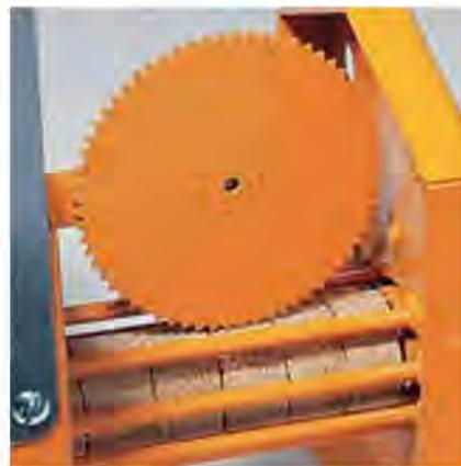
Surveillance électronique de la longueur des matériaux compactés par un générateur d'impulsions commandé par roue dentée avec extinction de la presse une fois la quantité de matériau épuisée.
