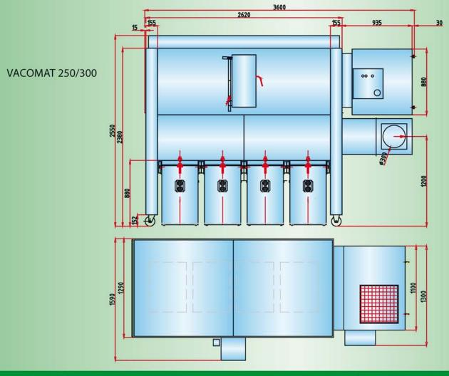
Le dépoussiérage sur mesure en fonction des besoins – Le Vacomat 250 et 300
