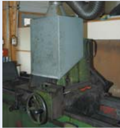
Photo 8. Rectifieuse avec capteur mobile.
