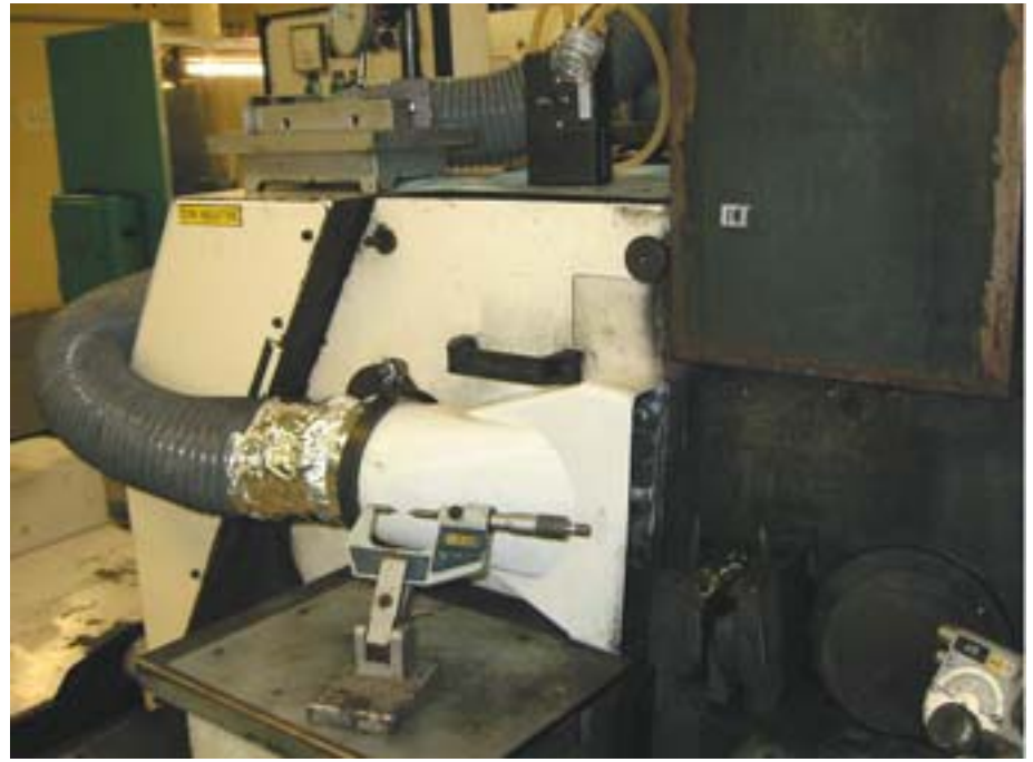
Photo 4. Dispositif de captage inducteur.
