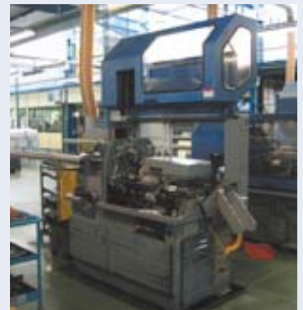
Photo 15. Capotage amovible d'un tour à décolleter.
