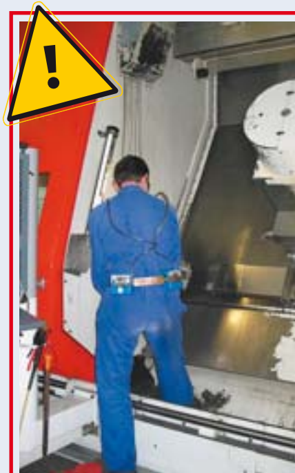
Photo 25. Bien que les valeurs au tour à commande numérique soient en deçà de la valeur recommandée, nous constatons lors du démontage de l'outil que l'opérateur doit pénétrer dans la zone d'usinage ce qui entraîne ponctuellement des expositions plus fortes (tour n°2).
