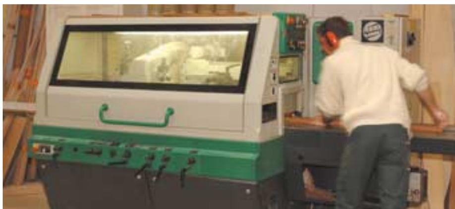
tion de la machine, en particulier son encombrement (dispositifs d'extraction et d'introduction d'air compris). Le constructeur doit indiquer notamment le(s) débit(s) d'air requis, la perte de charge correspondante, la vitesse minimale d'air au raccordement, l'emplacement de ce raccordement et son diamètre (section circulaire).
