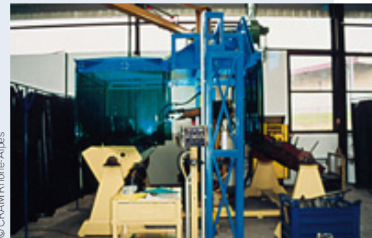
Fig. 38. Dispositif de captage repliable.
