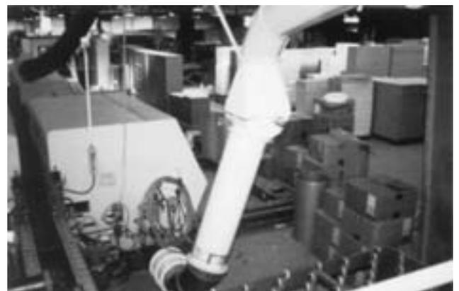
Fig. 10. Exemple de rotule et de tubes coulissants
